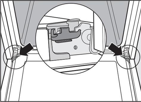
Die Tür ist durch Halterungen mit den Türscharnieren verbunden. Bevor Sie die Tür von diesen Halterungen abziehen können, müssen Sie erst die Sperrbügel an beiden Türscharnieren entriegeln.
